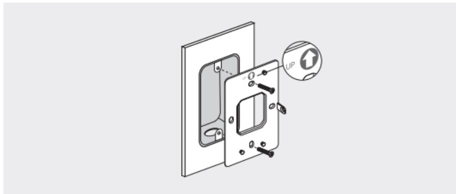
2. 將 AP 安裝到支架上。某些型號可能有螺絲孔，可透過螺絲來固定產品。
