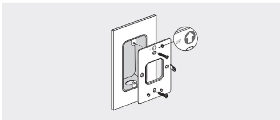
2. AP をブラケットに取り付けます。モデルによっては、ネジで製品を固定するためのネジ穴がある場合があります。
