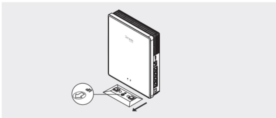
2. Tempatkan AP secara vertikal pada permukaan horizontal (seperti meja atau rak) yang jauh dari jangkauan anak-anak.
